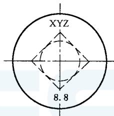
图 13 圆头方颈螺栓标志示例
