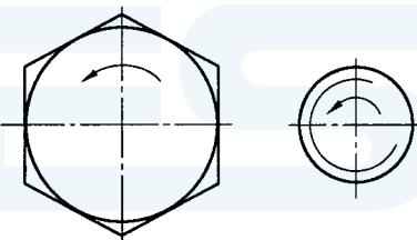
图 15 左旋螺纹的螺栓和螺钉的标志
