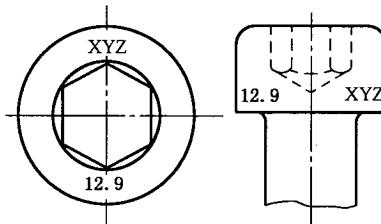
图 12 内六角圆柱头螺钉标志示例
