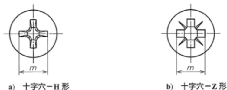
図 5—十字穴付き皿小ねじ—タイプ 2 の十字穴
